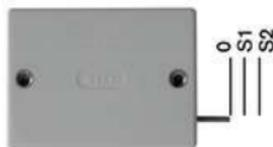
O interruptor de tração tem 2 pontos de comutação, que são acionados um atrás do outro e de forma independente um do outro. Para cada ponto de comutação é atribuída uma função do componente protético a ser controlado. Assim, o ponto de comutação 1 sempre deve estar atribuído com a função "fechar a mão".
