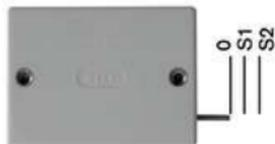
De trekschakelaar heeft 2 schakelpunten die na elkaar en onafhankelijk van elkaar te besturen zijn. Aan elk van beide schakelpunten is een functie van de aan te sturen prothesecomponent toegewezen. Daarbij moet aan schakelpunt 1 altijd de functie „hand sluiten“ zijn toegewezen.
