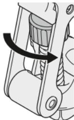
**③** Austauschen der Feder/Replacing the spring
